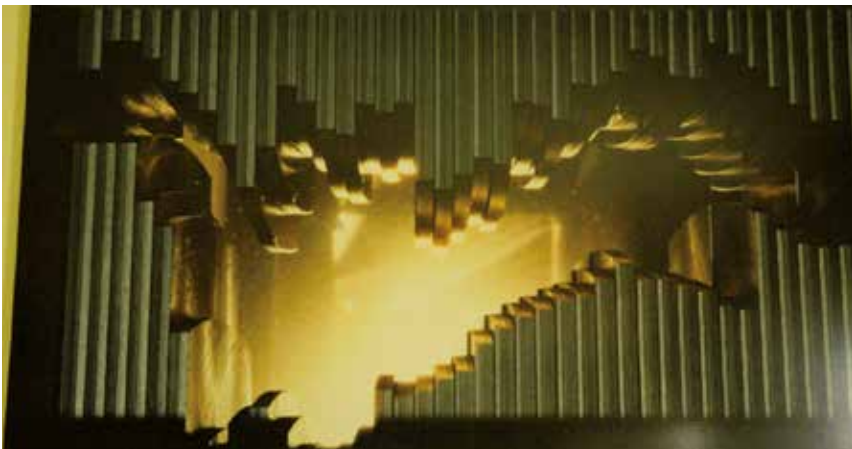
Hierboven ziet u een voorbeeld van de grillige vorm die een multi leaf collimator kan aannemen.
